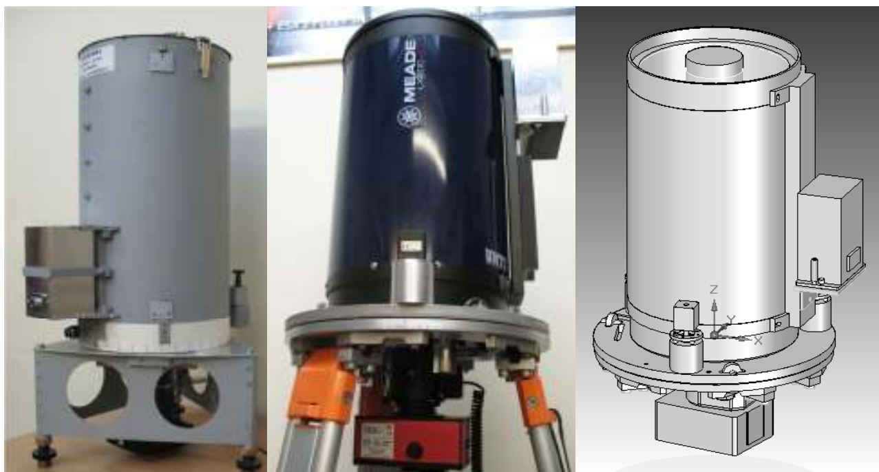
6.1. att. Digitālās zenītkameras prototips (pa kreisi), gala konstrukcija (vidū) un gala konstrukcijas projektējums (pa labi)
